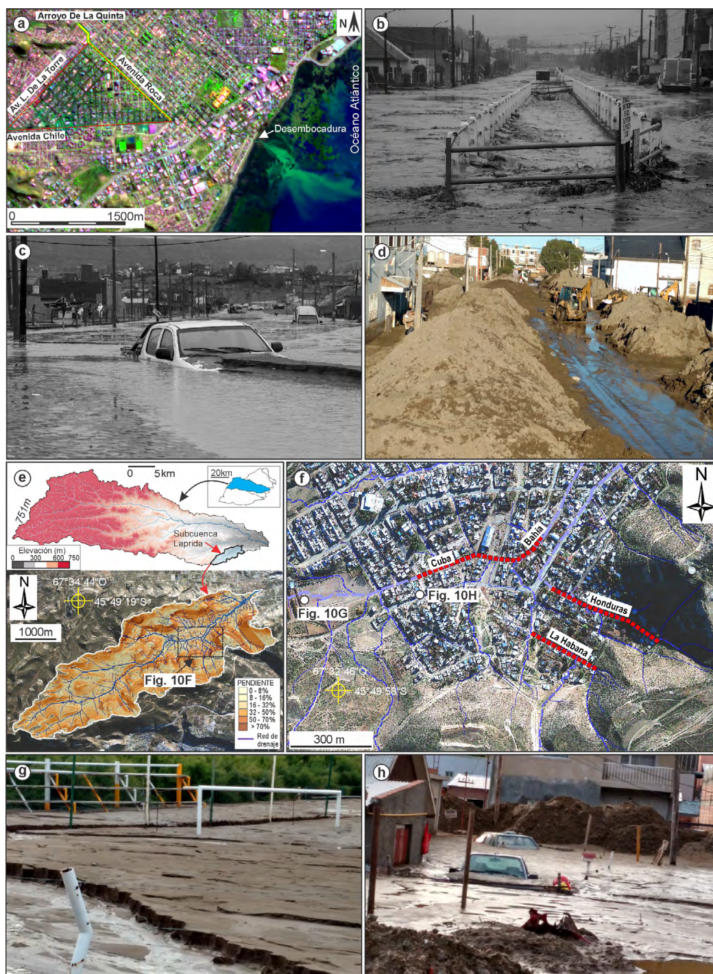
Figura 10. Inundaciones urbanas: a) Imagen Sentinel 2 de parte de la cuenca De La Quinta (composición de las bandas 12-8-2) dentro del área urbana (ubicación en figura 7a). Los colores verdes a oscuros reflejan zonas de alto contenido de humedad. El área definida por las avenidas Roca, Chile y Lisandro de la Torre fueron inundadas con más de 2 m de arena debido a ineficiencia del pluvial de la avenida Roca, principal colector del agua que ingresa a la ciudad; b) Fotografía de la Avenida Roca obtenida el 30 de marzo de 2017 (mirando aguas arriba) con el agua de lluvia movilizándose principalmente por la calle (fotografía de David Alejandro Muñoz); c) Vehículos y sedimento transportado durante el temporal fueron depositados en depresiones endorreicas de la cuenca De La Quinta. Fotografía de D.A.: Muñoz obtenida el 04 de abril de 2017; d) Remoción del sedimento depositado en la ciudad. Fotografía tomada el 16 de abril de 2017; e) Ubicación de la subcuenca Laprida en relación a la cuenca del arroyo Belgrano; f) Área urbana del barrio Laprida afectada por las inundaciones, y principales vías de evaluación del agua de lluvia. Se indica la posición de la figura 10 g-h; g) Cancha de fútbol ubicada en el acceso oeste del barrio Laprida, con más de 150 cm de arena fina; h) Sepultamiento de viviendas y vehículos en barrio Laprida. Fotografías obtenidas el 8 de abril de 2017.
