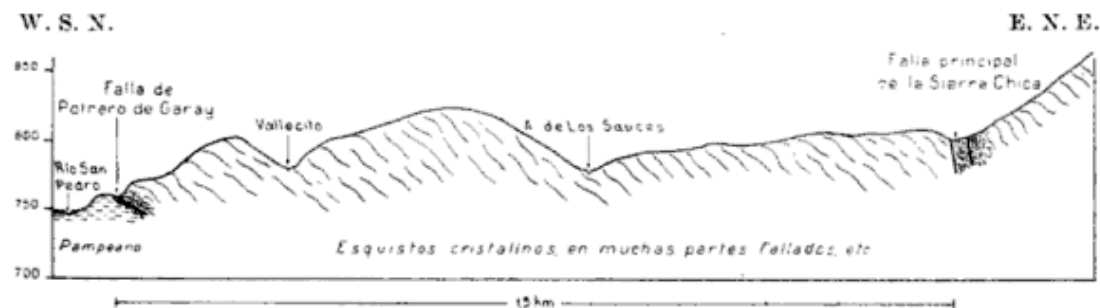
Fig. 5. — Perfil esquematizado para demostrar la situación de la falla de Potrero Garay con referencia a la falla principal de la sierra Chica
