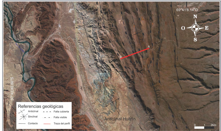
Figura 2. Ubicación de la zona de estudio. Imagen de la zona de Las Salinas y parte del flanco occidental del Dorso de los Chihuidos con las principales estructuras mapeadas. La transecta roja representa la ubicación del perfil realizado.
