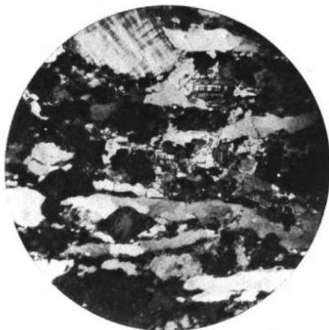
Fig. 9. — Granito milonítico del Cerro de la Virgen. Los cristales dimensionales orientados en forma casi paralela corresponden a cuarzo recrystalizado. Entre ellos se observa abundante microclino y en menor proporción plagioclasa. Nícoles cruzados, \times 12 .
