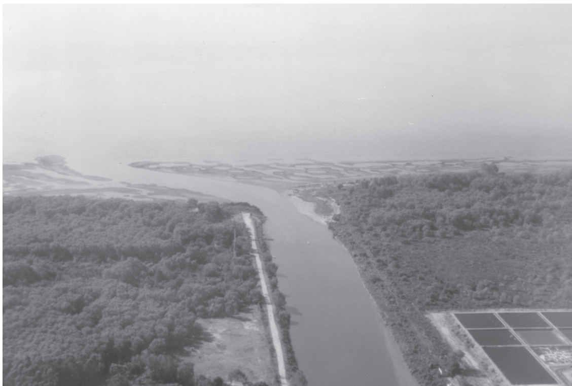
Figura 2: Cursos de agua artificiales desplazados hacia el norte por las corrientes de deriva litoral generadas durante las sudestadas, arroyo Sarandí, partido de Avellaneda.
