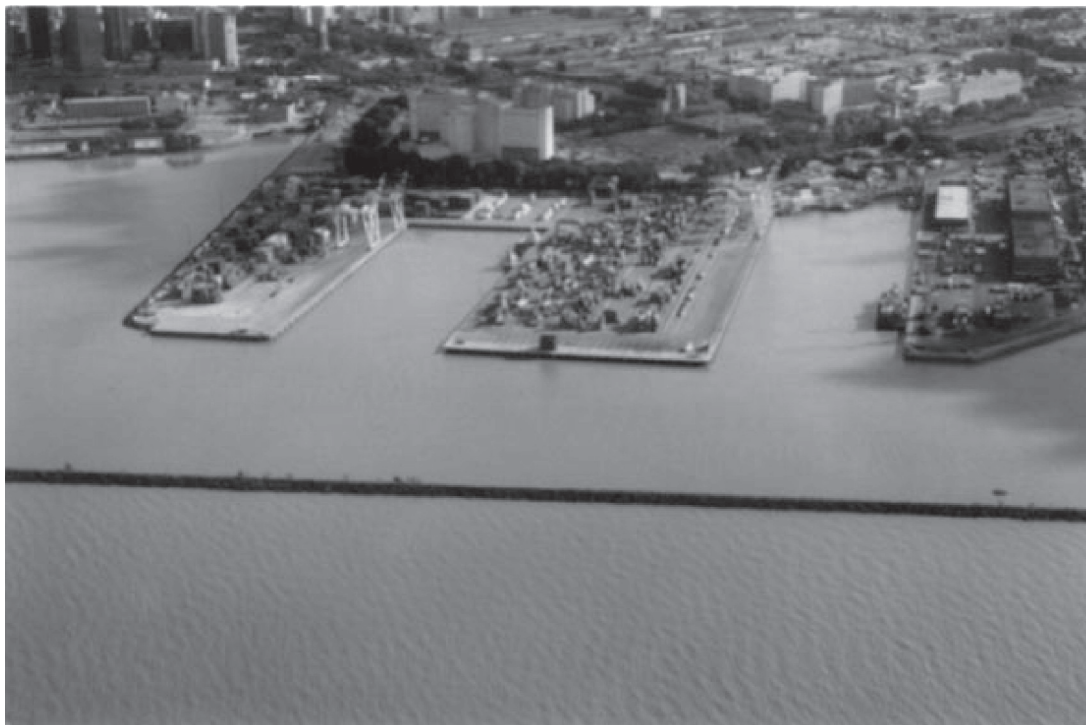
Figura 6: Foto aérea que muestra un albardón de relleno de tipo barrera en la zona del puerto de la ciudad de Buenos Aires. Su evolución se ve alterada por las sucesivas tareas de dragado para el mantenimiento del puerto.
