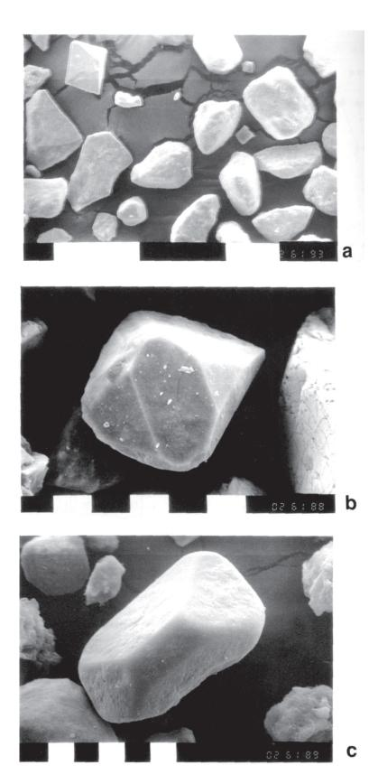
Figura 7: Cristales de magnetita e ilmenita observados mediante microscopía electrónica de barrido, SEM 505. a) Cristal octaédrico de magnetita hacia el ángulo superior izquierdo (350 aumentos, escala 100 μm); b) cristal rombododecaédrico de magnetita (1500 aumentos, escala 10 μm); c) cristal romboédrico de ilmenita (1000 aumentos, escala 10 μm).
