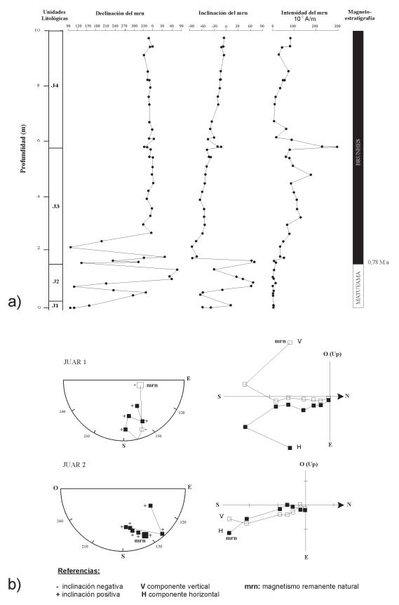
Figura 3: a) Magnetoestratigrafía de la cantera de Juárez. Valores direccionales (declinación e inclinación) y no direccionales (intensidad) del magnetismo remanente natural (mrn) en relación con el perfil geológico. b) Redes estereográficas y diagramas de Zijderveld de dos muestras de polaridad reversa de la cantera de Juárez.
