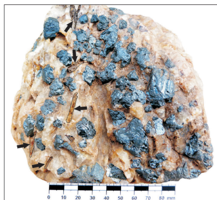
Figura 2. Fotografía de cristales de rutilo incluidos en cuarzo (muestra estudiada). Las flechas señalan algunas cavidades elongadas subparalelas, con moldes estriados, parcialmente rellenas de goethita o totalmente lixiviadas, correspondientes a cristales de hematita alterados. Los cristales de ambas especies se hallan agrupados en primer plano delineando una grosera estructura planar.
