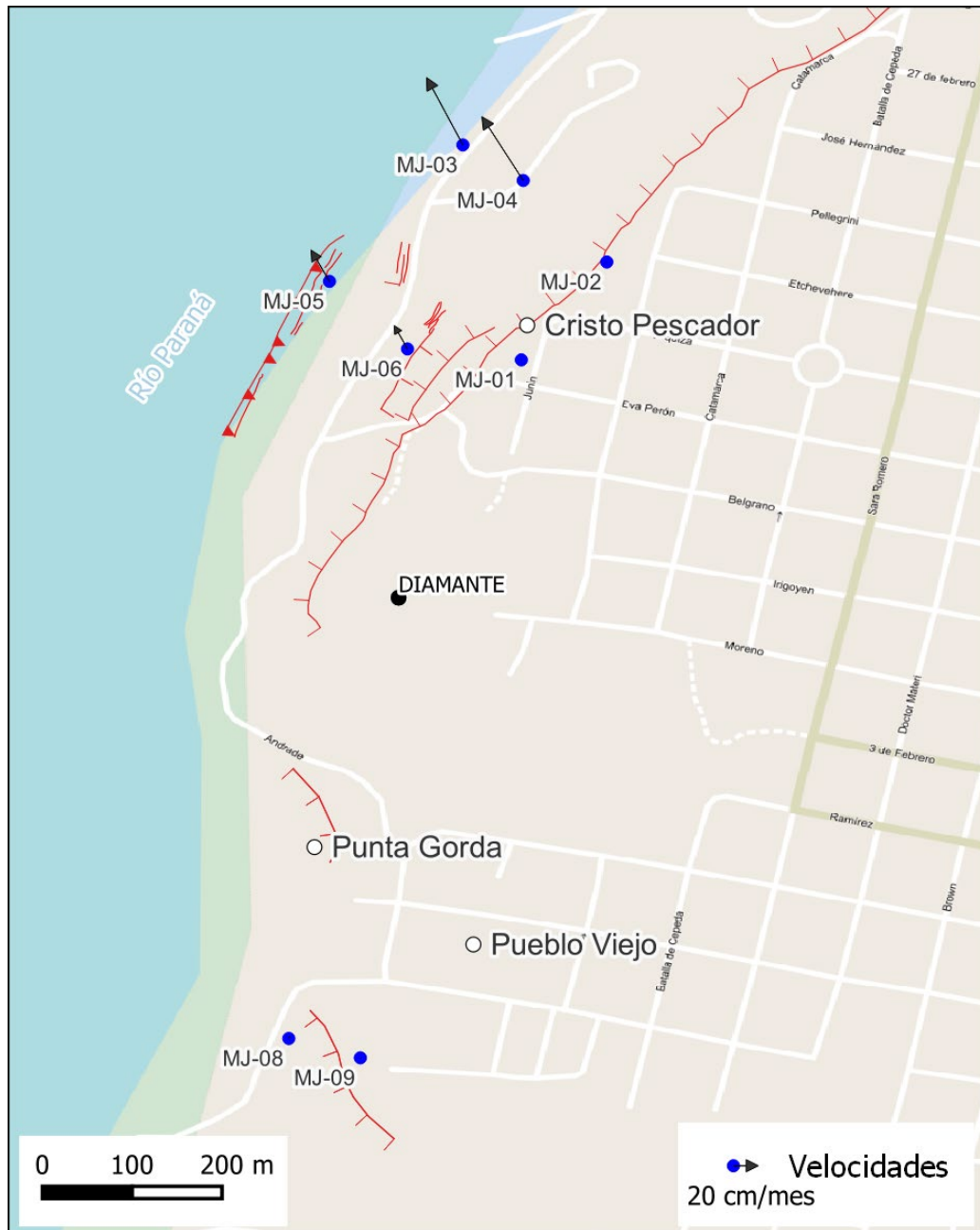
Figura 13. Desplazamientos de puntos de monitoreo en zona afectada por el proceso de remoción en masa. El campo de velocidades se expresa en cm/mes.
