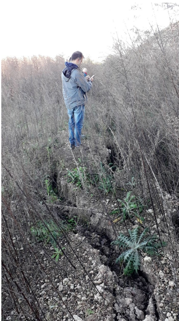
Figura 17. Fracturas de distensión en arcillas y materiales de mezcla, en zonas de domos elongados paralelos al frente de barranca, en la planicie baja del balneario de la Aldea Valle María. El sitio de las observaciones se encuentra a 6,3 km al Norte, a lo largo de la costa de la zona afectada por los fenómenos estudiados en Diamante.
