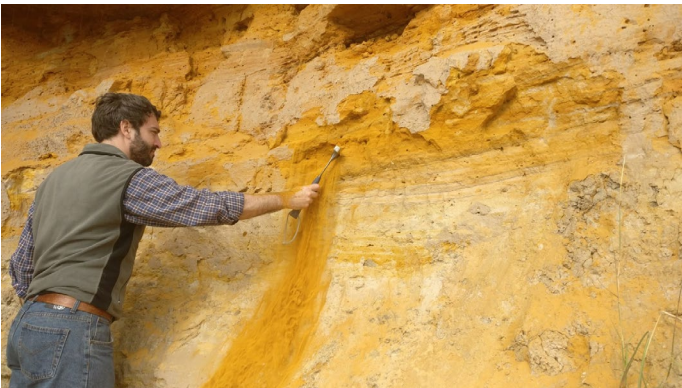
Figura 5. Areniscas color ocre, muy friables, pertenecientes al miembro inferior de la Formación Ituzaingó. Puede apreciarse cómo se desgranar al rasparlas con el martillo.
