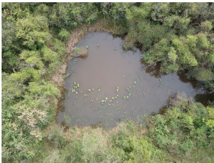
Figura 11. Vista aérea desde tomada desde un vehículo no tripulado de una laguna natural, sin aporte ni evacuación superficial, formada tentativamente por procesos de disolución, o bien por colapso o tubificación. Se ubica a 25 metros del borde superior de la barranca.
