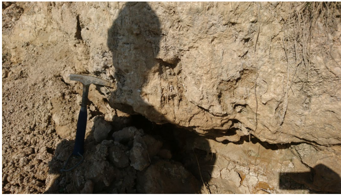
Figura 7. Detalle de las calizas de la Formación General Alvear, de elevada resistencia y baja erodabilidad.
