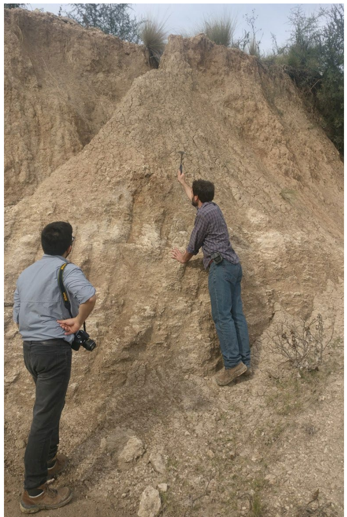
Figura 9. Sector inferior de la Formación Hernandarias, compuesto por arcillas blancas grisáceas, con presencia de concreciones carbonáticas.
