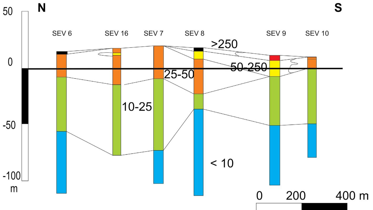
**Figura 6:** Perfil hidrogeológico esquemático de la Barrera Medanososa Austral en Dunamar (valores en  $\Omega \cdot m$  modificado de Cesare 2016).
