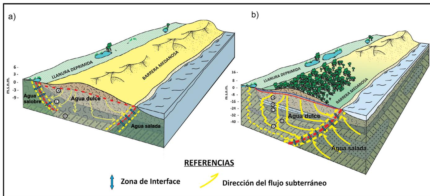
**Figura 4:** Esquema hidrogeológico de interfase agua dulce-agua salada en la Barrera Oriental. a) al norte (San Clemente del Tuyú), y b) al sur de la barrera (Pinamar) (modificado de Rodríguez Capítulo 2015).
