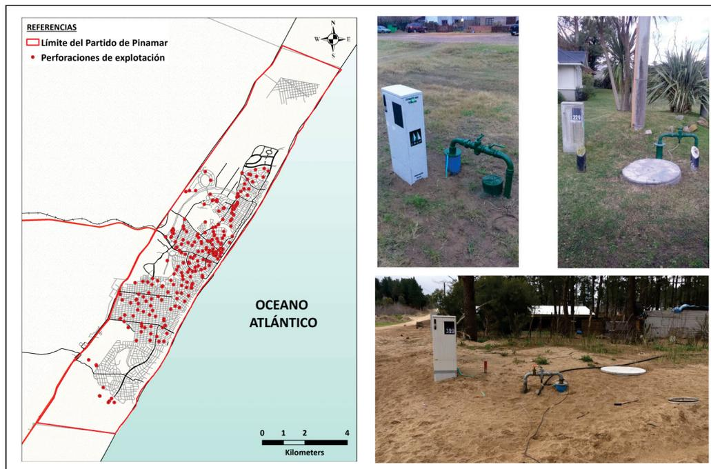
Figura 12: Método de explotación convencional en Pinamar.
