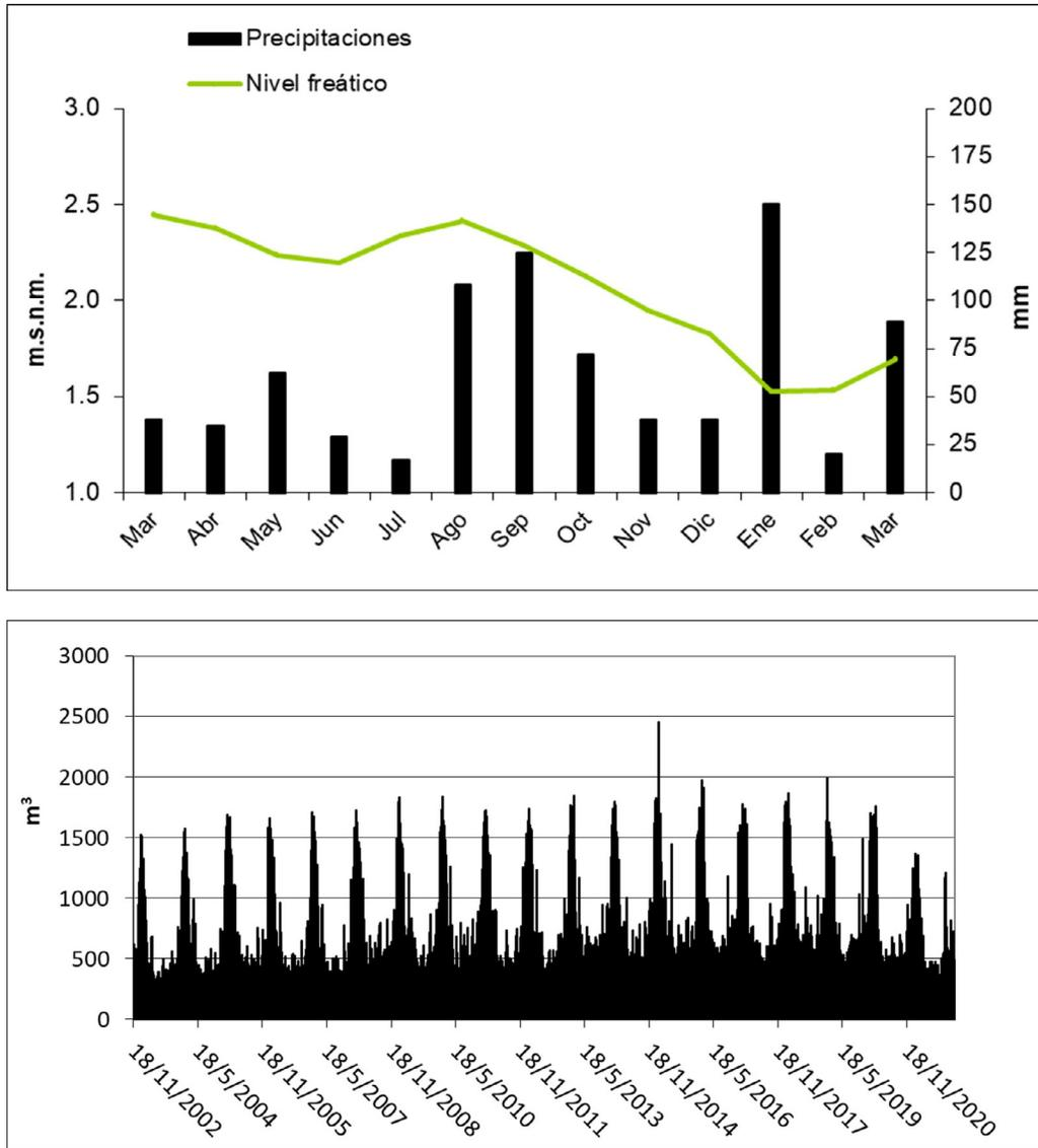
**Figura 7:** Arriba: Fluctuación de la capa freática y precipitaciones para un año hidrológico (Carretero 2011). Abajo: Producción diaria de agua para abastecer San Clemente del Tuyú en el intervalo 2002-2021.
