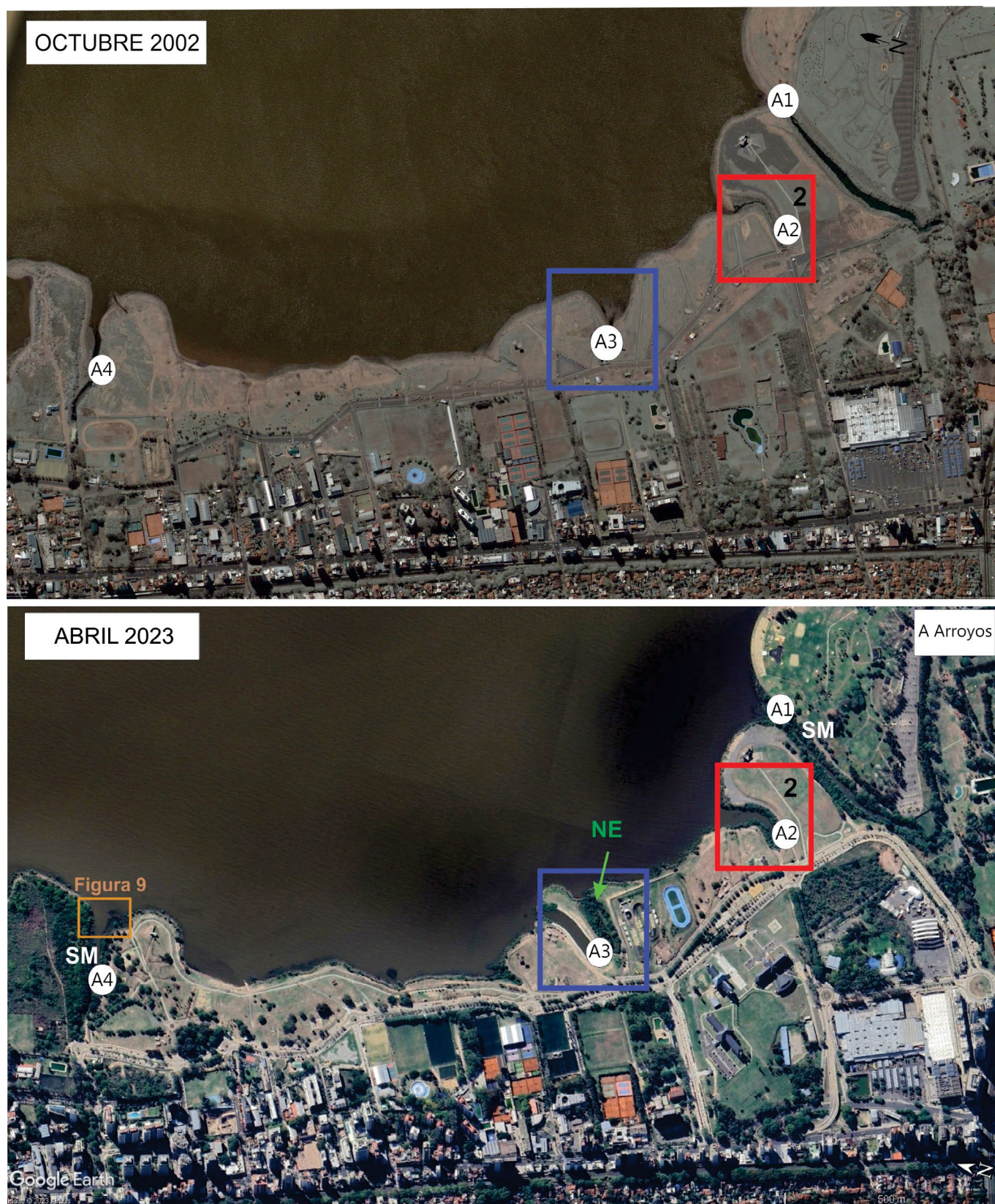
Figura 5. Comparación de la evolución de los arroyos en los últimos 20 años. Nueva canalización del curso A3 con revestimiento de hormigón y abandono del canal original generando un nuevo ecosistema (NE). Ensanchamiento del canal A2 (2). Formación de selva marginal canales (SM).
