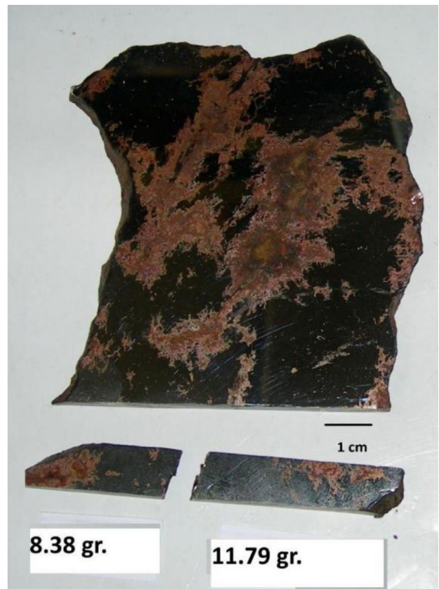
Figura 5. Rebanada del meteorito Ñorquin con un detalle de los 8.38 gramos enviados para análisis.
