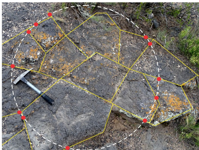
Figura 4. Estimación de parámetros de una población de fracturas mediante el método de línea de muestreo y ventanas circulares de Mauldon et al. (2001). El círculo (línea circular de muestreo) encierra un área de 1.5 \text{ m}^2 (ventana). Para el afloramiento de la imagen se determinó una longitud de fracturas ( L ) de 5.41 \text{ m} ( \bar{L}=0.21 \text{ m} ), una intensidad de fractura ( I ) de 6 \text{ m}^{-1} y una densidad de fractura de 25 \text{ m}^{-2} .
