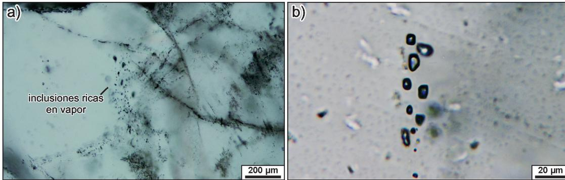
**Figura 8:** Fotomicrografías con luz transmitida en secciones bipulidas; a) Trenes de inclusiones secundarias ricas en vapor cortando cristales de cuarzo; b) Detalle de las inclusiones ricas en vapor.
