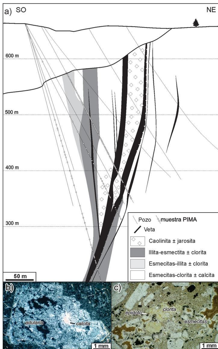
**Figura 7:** a) Distribución de las asociaciones de alteraciones hidrotermales interpretadas a partir de los datos de PIMA en perfil (ver Fig. 3a); b) Fotomicrografía de feldespato en andesita, reemplazado por adularia y calcita tardía; c) Fotomicrografía de minerales máficos en andesita, reemplazados por clorita y epidoto con esmectitas tardías en cavidades.
