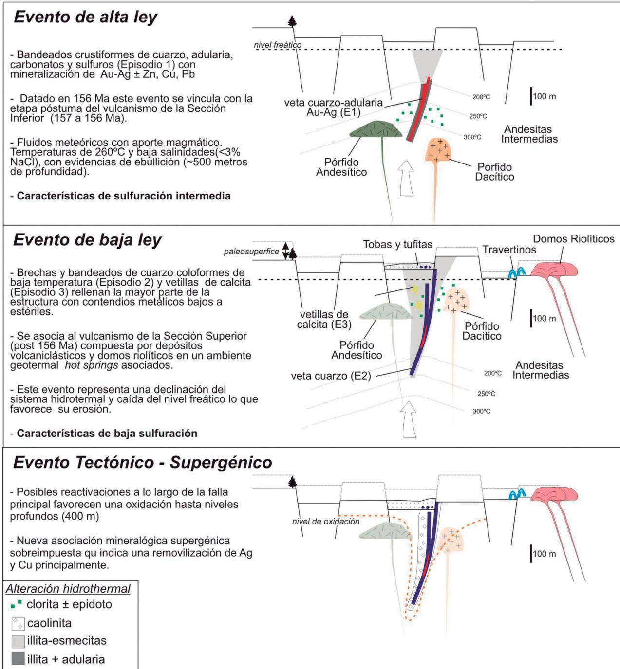
Figura 11: Modelo evolutivo para la formación del clavo mineralizado Eureka West.
