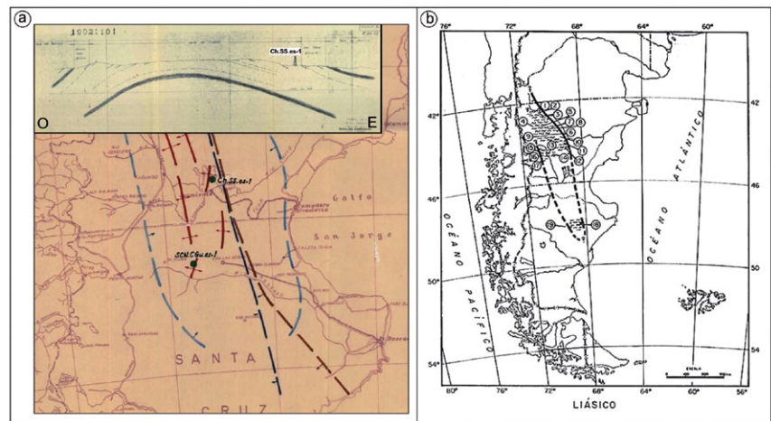
Figura 10: Exploración del Liásico y del Paleozoico superior. a) Plano de ubicación de los pozos Cerro Guadal es-1 y Sierra Silva es-1. En el inserto se muestra el corte estructural O-E del anticlinal de sierra Silva con el pozo propuesto (Propuestas de perforación, YPF 1969). b) Distribución del Liásico en Chubut y Santa Cruz norte (Lesta y Ferello 1972).
