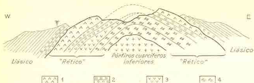
Fig. 15. — Perfil transversal algo esquemático al S del Keli Maluida : 1, toba amarillenta, dacítica; 2, conglomerados; 3, toba verdosa, porfirica; 4, toba parda, basáltica.
