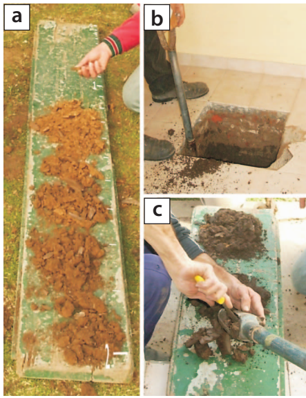
Figura 8: a) Perfil litológico reconstruido en superficie con las muestras de materiales del subsuelo obtenidas a distintas profundidades. b) Ejemplo de corte en un piso de cerámicos, dentro de una habitación, para acceder al subsuelo. c) Obtención de los materiales extraídos por la cuchara del barreno manual.
