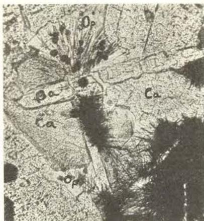
Fig. 8. — La calcita (Ca) contiene en su interior agregados aciculares de manganita (Mn) y es contemporánea de la barita (Ba). El ópalo (Op) se lo ve penetrando a través de la calcita y la barita y arrastrando manganita. Fluorita (Fa).
