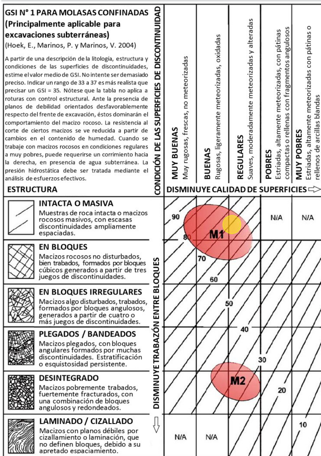
Figura 9. Estimación del GSI para macizos rocosos heterogéneos molásicos confinados (modificado de Hoek et al. 2005), de aplicación en túneles y cimentaciones profundas. Se indica una caracterización con valores de GSI en el entorno de 70.
