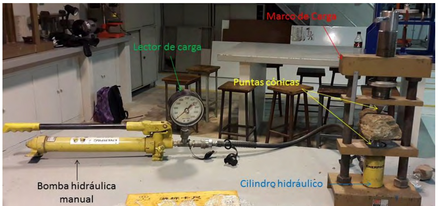
Figura 6. Equipo utilizado para la ejecución de los ensayos de resistencia a la carga puntual, según norma ISRM (1985), propiedad de la Universidad Tecnológica Nacional, Facultad Regional Buenos Aires (UTN - FRBA).
