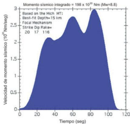
**Figura 2:** La tasa de liberación de momento sísmico representa una medida de cómo se liberó la energía en la falla (tres pulsos siendo el siguiente mayor que el anterior) y su duración total fue de 110 s. La función de la velocidad del momento sísmico promedio se observa en forma ortogonal al rumbo de la falla.
