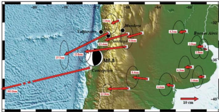
**Figura 10:** Desplazamientos co-sísmicos observados como resultado de la activación de la falla en el contacto entre las placas de Nazca y Sudamericana. El máximo desplazamiento horizontal en esta figura alcanza a 3,7 m en la ciudad de Concepción (Proyecto CAP, M. Bevis y colaboradores). Para la ciudad de Constitución, C. Vigny (comunicación personal) reporta al menos 4,7 m de desplazamiento horizontal.
