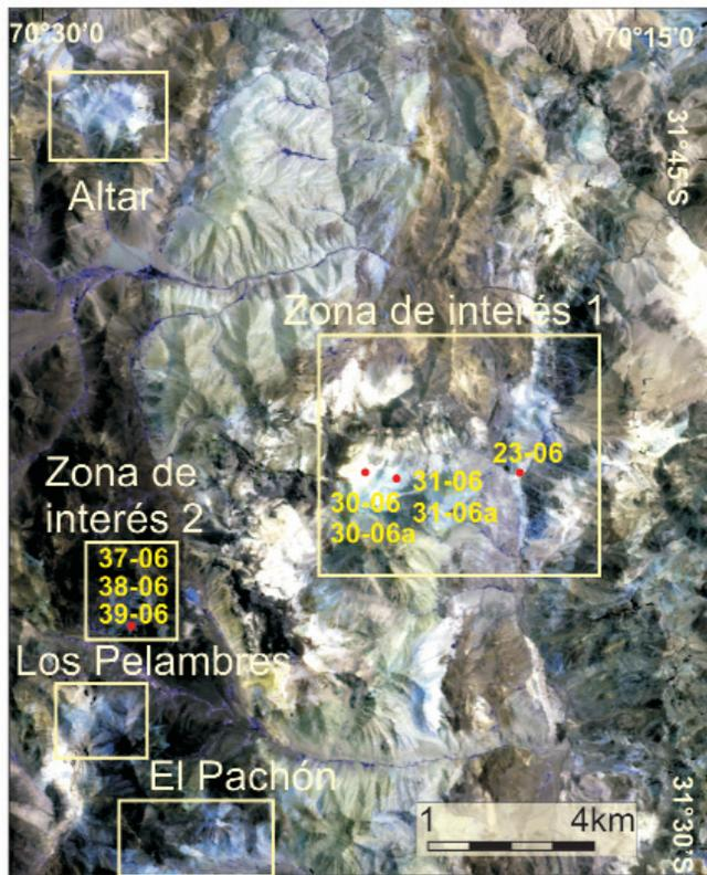
**Figura 2:** Combinación de bandas RGB: 654, con las zonas de alteración en color azul claro; y ubicación de las muestras extraídas estudiadas con espectrometría de reflectancia.
