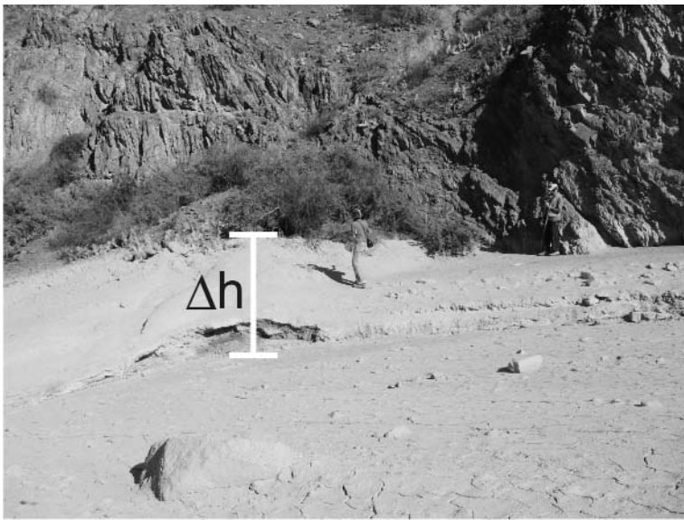
Figura 11: Mediciones para el cálculo de la velocidad según la ecuación de Chow (1959).
