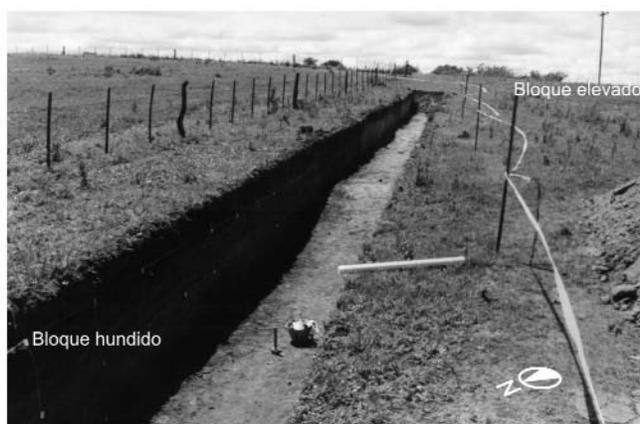
**Figura 4:** Vista general de la trinchera T2, Estancia Vieja, excavada en sedimentos cuaternarios perpendicular a la escarpa de la falla Las Lagunas.
