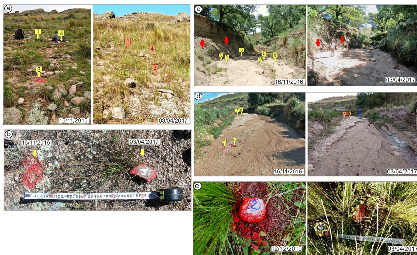
Figura 10: Ejemplos de monitoreo de clastos pintados y abanicos coluviales. En la cuenca arroyo Arenoso: a) Desplazamiento de clastos en el talud (toposecuencia tipo A) para dos fechas del monitoreo; b) Vista en detalle, de la figura 10a, de uno de los clastos desplazados; c) Erosión de abanicos coluviales (señalados con flechas rojas) y monitoreo de clastos en el canal principal (señalados con flechas amarillas) para dos fechas del monitoreo; d) Monitoreo de clastos en el canal principal (señalados con flechas amarillas). Los clastos sin desplazamiento son señalados con flechas naranjas. En la cuenca arroyo Moyano: d) Clasto sin desplazamiento en el talud (toposecuencias tipo G) para dos fechas del monitoreo.
