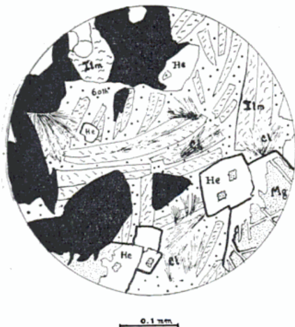
Fig. 4. — Textura característica de las vetas de hierro del Leoncito (veta Mary). Los principales minerales de mena, magnetita (mg) octaedral e ilmenita (ilm), en cuerpos redondeados o en cristales tabulares curvados, han sido reemplazados por meta-cristales de turmalina (negro). Por oxidación la magnetita pasó casi totalmente a hematita (he) o goethita (goth) quedando solamente en forma relicta. La ilmenita permanece todavía inalterada. Además hay clorita secundaria (cl).
