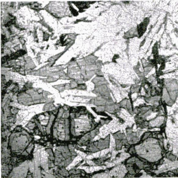
Fig. 8. — Diabasa con textura ofítica, la olivina está parcialmente alterada y el mineral opaco, tabular o acicular es ilmenita-hematita. ( $\times 20$  s/nic.).
