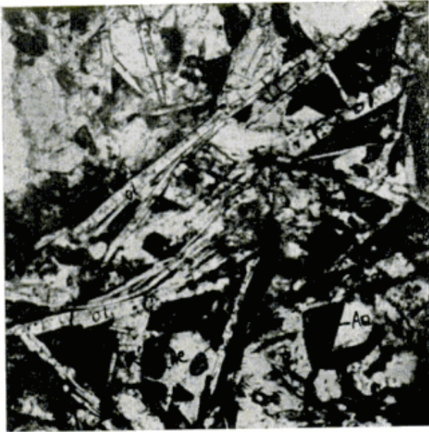
Fotog. 4. — Vena de grano fino de la parte superior del cerro Cresta formada por una pasta de textura intergranular a intersertal. Los minerales más abundantes son: oligoclasa (ol), y aegirina. Obsérvese la curvatura que presentan las largas tablillas de plagioclasa. Sin analizador objetivo \times 10 .
