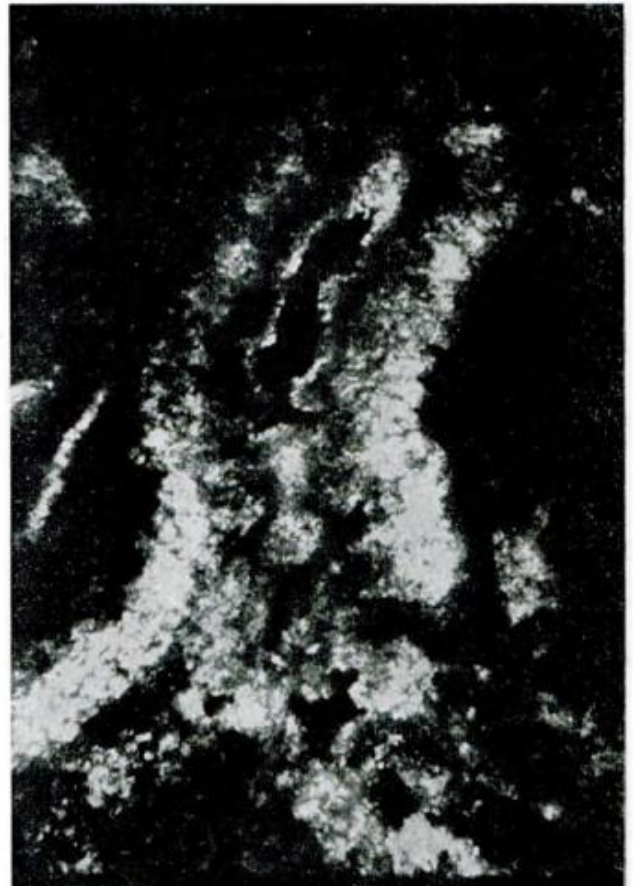
D. — Discontinuidad litológica o costra bandeada. Se observa claramente la diferencia entre la proporción de plasma y esqueleto entre los dos sectores. ( \times 35 ).
