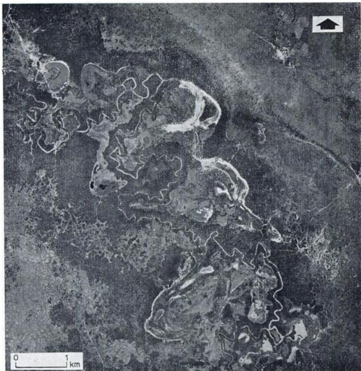
Aerofoto 1. — I. G. M., 6B-221-7783. Escala 1 : 50.000. Arroyo Monte Lindo Chico : meandros tortuosos muy irregulares ; en la llanura aluvial se observan meandros abandonados de mayor dimensión que los actuales.
