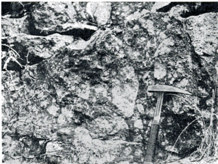
Fotografía 5. — Detalle de la roca de caja fuertemente brechada con clastos de 25 cm de diámetro, y clastos más pequeños de cuarzo. Esta brecha está cementada por óxidos de manganeso impuros (pared nordeste del rajo mayor).
