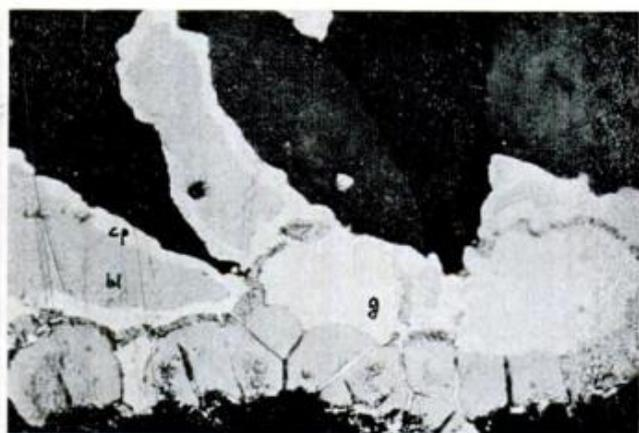
Fig. 2. — Inmersión en aceite.  $\times 100$ . Pechblenda botrioidal, gersdorffita (g), blenda (bl) y calcopirita (cp).
