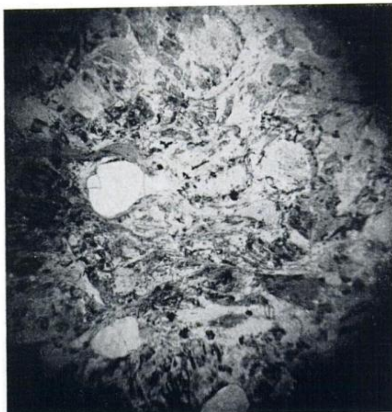
Fotog. 2. — Ignimbrita. Corte delgado. \times 25 . Nícoles paralelos. Nótese el fuerte grado de aglutinación y deformación de las trizas
