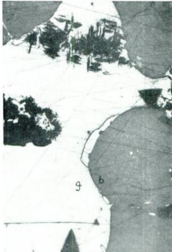
Fig. 7.—6-A-406. Detalle de dos medialunas de pirrotina en el contacto blenda (b) galena (g). Dentro de galena barbas de sericita.
