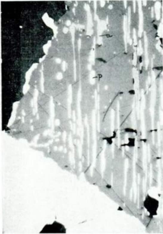
Fig. 8. — 12-G-287-DS. Grano de blenda con inclusiones orientadas de pirrotina (p) y alabandino (a).
