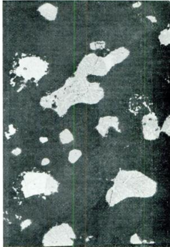
Fig. 5.—6-A-406. Arreglo metamórfico. Blenda (b) con inclusiones de calcopirita (c) y pirrotina (p). Galena (g) reemplazada por minerales de ganga.
