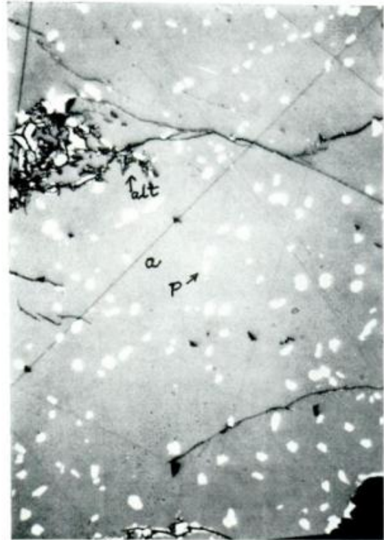
Fig. 9. — 12-G-287-DS. Alabandino (a) con desmezclas subidiomorfas de pirrotina (p), mostrando también su típica alteración (alt.).
