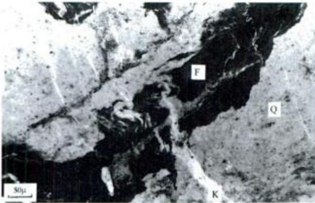
Figura 4: Microfotografía de pseudomorfos de fragmentos piroclásticos (F) atravesados por venillas discordantes de caolinita (K). Q: cuarzo. Nivel arcilloso Cantera 1. Nícoles cruzados.
