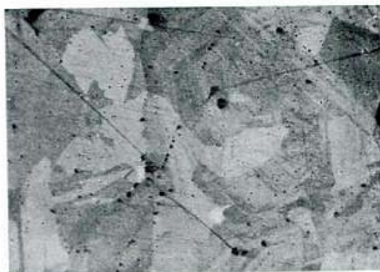
Fig. 2. — Inmersión en aceite. Nicoles paralelos. x 300. Luzonita l.s. Se observa zonación, tras-pasando a las maclas y a diferentes granos. Mina Upulungos.
