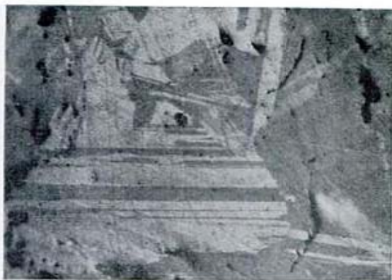
Fig. 1. — Inmersión en aceite. Nicoles paralelos. x 300. Típicas maclas de luzonita l.s. Mina Upulungos.
