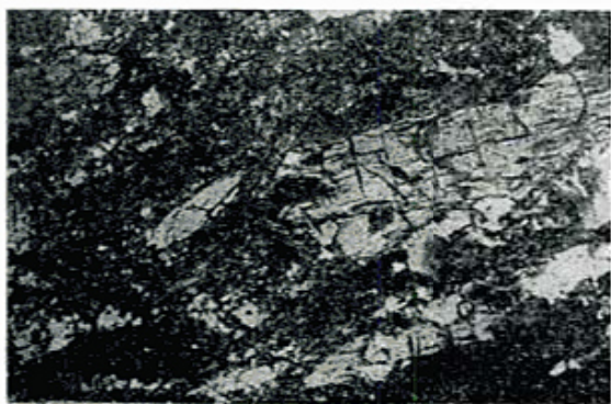
Fotomicrografía 12. — Anfibolita hornblendífera epidótica, con textura porfiroclástica. Quebrada del Chorro. Sin analizador, x20.
