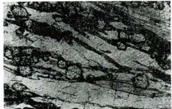
Fotomicrografía 3. — Granates estáticos en esquistos de la zona aguas arriba de la quebrada del Chorro. Sin analizador. x20.
