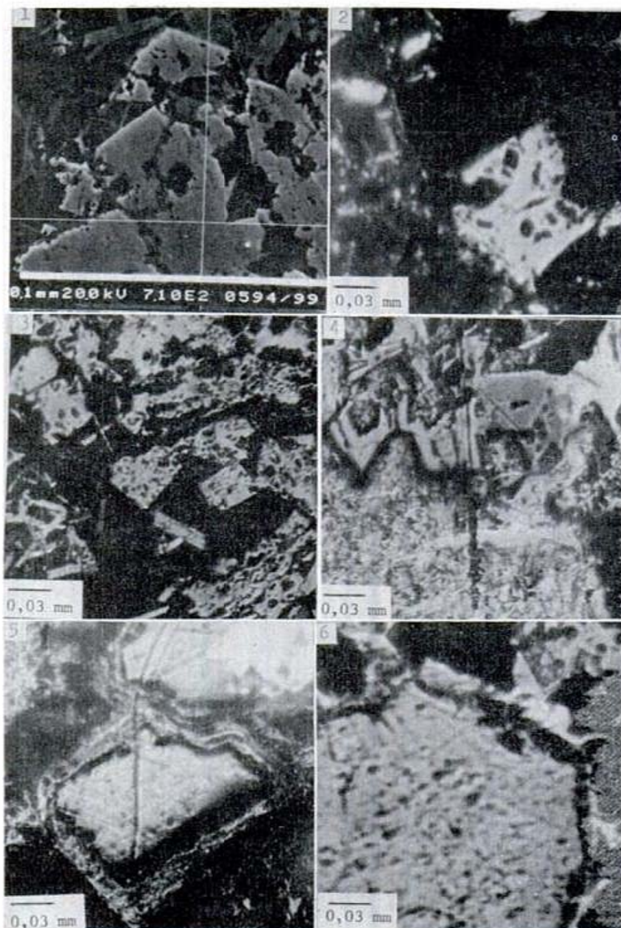
Figura 1: Fotografía con microscopio electrónico de hetaerolita, los datos que figuran al pie indican de izquierda a derecha, el valor del segmento blanco, el Kilovoltaje de excitación de los electrones y el aumentos expresado en potencias de diez. Figura 2: Cristales de hetaerolita maclados, en ganga de calcita (negro). En aceite, N//. Figura 3: Cristales idiomorfos de hetaerolita asociados a tablillas de calcofanita, en calcita (negro). En aceite, N//. Figura 4: Relictos de cristales de hetaerolita dentro de un agregado fibroso de calcofanita (mineral fuertemente pleocroico). El mineral blanco en el borde superior izquierdo es criptomelano que está reemplazando pseudomórficamente a hetaerolita. En aceite, N//. Figura 5: Cristales de goethita (gris) pseudomórficos de pirita, conteniendo relictos de este sulfuro (blanco). La goethita está reemplazada centrípetamente por hetaerolita (gris oscuro). En aceite, N//. Figura 6: Cristales de goethita (gris) pseudomórficos de pirita están reemplazados centrípetamente por hetaerolita (gris claro) y criptomelano (blanco). Arriba a la izquierda hay un cristal idiomorfo de hetaerolita. En aceite, N//.
