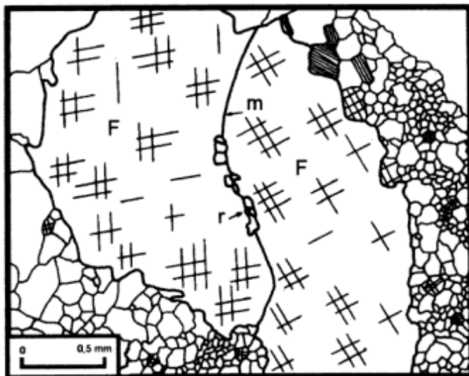
Figura 10. Dibujo al microscopio de un porfiroclasto de feldespato potásico deformado ductilmente (F), con el plano de macla curvado (m), granos recrystalizados en el mismo (r) y maclado en pa-rrilla secundario.
