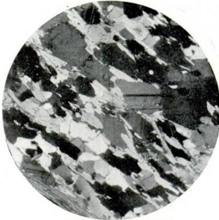
1. Filita cuarzosa, inyectada Fotomicrografia, nicoles cruzados. Falda alta de la sierra, a la altura del río del Zarzo. En la mitad inferior izquierda se ve la roca poco o nada modificada por inyección; cuarzo y mica (biotita y muscovita) predominan. En la parte superior derecha, cerca del centro, cruza una delgada vena cuarzo-oligoclásica, del tipo de las de la lámina II, 1. Al microscopio, la distinción entre vena y esquisto resulta menos definida que a simple vista. Muestra 170. \times 40 .
