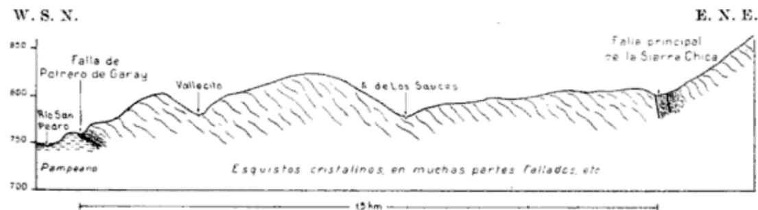
Fig. 5. — Perfil esquematizado para demostrar la situación de la falla de Potrero Garay con referencia a la falla principal de la sierra Chica
