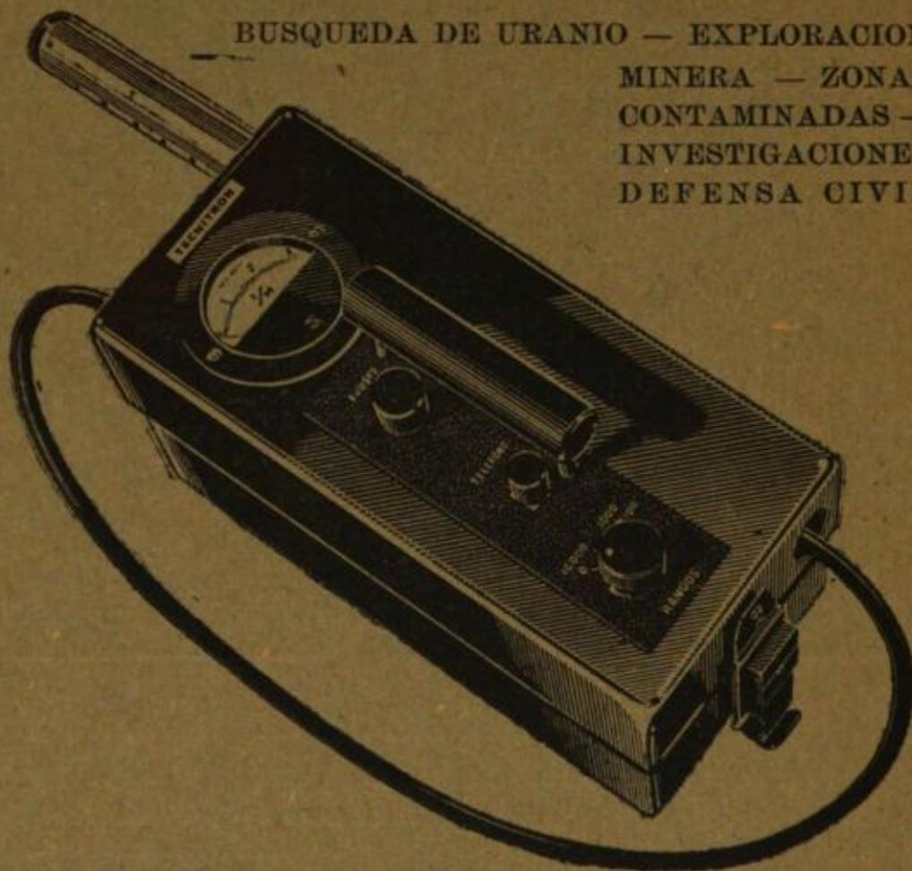
El detector Geiger Müller, marca D.W.G., modelo W 55, completamente portátil, es un instrumento de características sobresalientes para la detección y medida de radiaciones beta y gamma. Su gran sensibilidad permite detectar hasta los yacimientos más pequeños del mundo.
