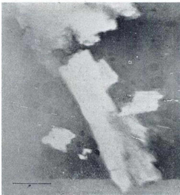
Fig. 2. — Material saponítico de Calamuchita. Micrografía electrónica que muestra una partícula alargada. Nótese el extremo desgarrado, mostrando láminas delgadas del material; la hoja exterior está plegada. En la sección superior de la micrografía, aparece una partícula con bordes no definidos. La partícula de la sección inferior izquierda puede ser un fragmento de la partícula en forma de cinta.
