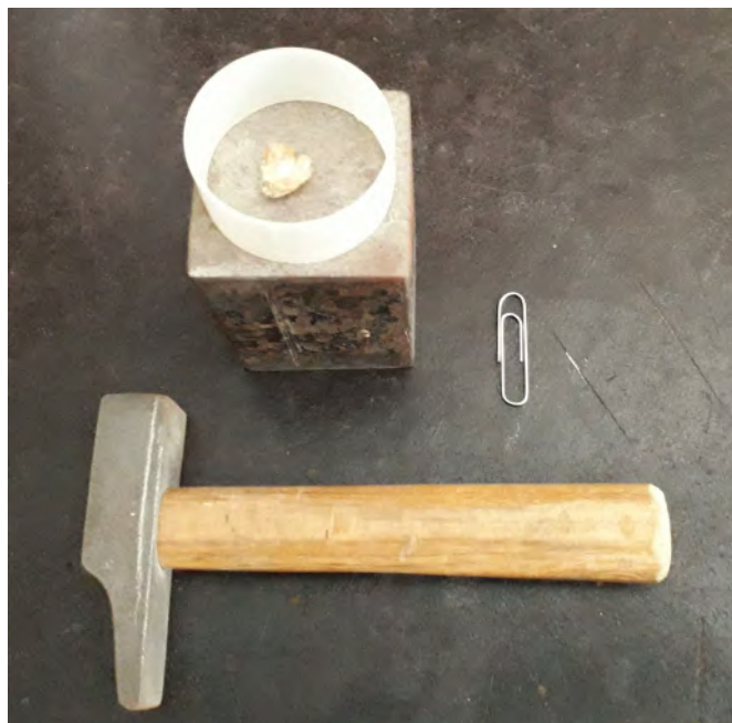
Figura 6: Yunque pequeño, aro de plástico que impide las proyecciones del mineral que se está moliendo y martillo usados por Juana en la preparación primaria del mineral problema. En la fotografía, grano de plagioclasa y cuarzo, orientado a determinar la composición de la primera luego de su molienda y tamizado.
