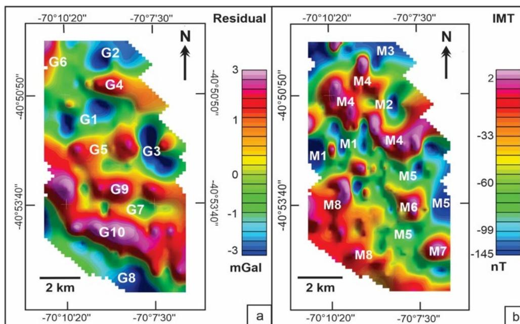
**Figura 1.** a) Mapa de la componente residual de la anomalía de Bouguer; b) Mapa de la Intensidad Magnética Total (IMT). Los rasgos G1 a G10 (Fig. 1a) y M1 a M8 (Fig. 1b) constituyen altos y bajos gravimétricos y magnéticos, respectivamente, definidos y caracterizados en este trabajo.
